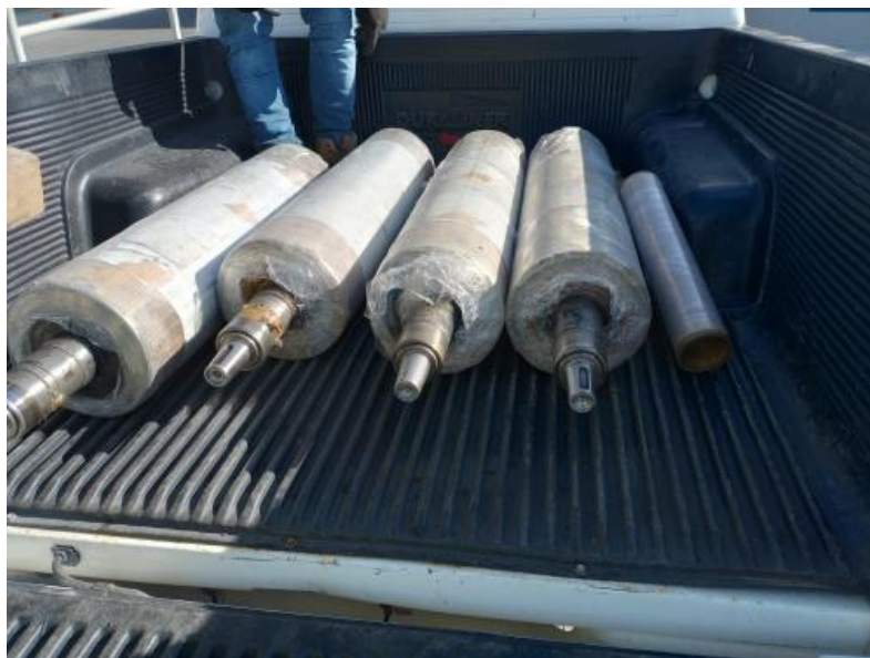
Figura 63. Rodillos dañados por daño en cuerda por tornillos capados ( Fuente: Elaboración propia)
