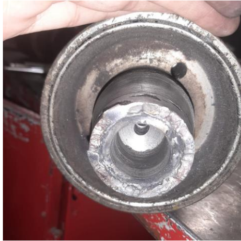
Figura 40. Daño en espiga de rodillo (Fuente: Elaboración propia)
