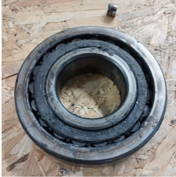
Figura 38. Rodamiento dañado (Fuente: Elaboración propia)
