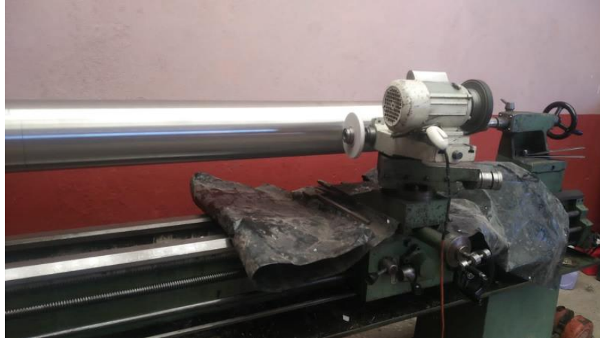
Figura 41. Rodillo en reparación con proveedor ( Fuente: Elaboración propia)
