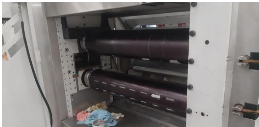
Figura 37. Rodillos del embossing dañados (Fuente: Elaboración propia)
