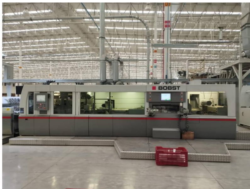
Figura 25. Troquelado del cartón (Fuente: Elaboración propia)
